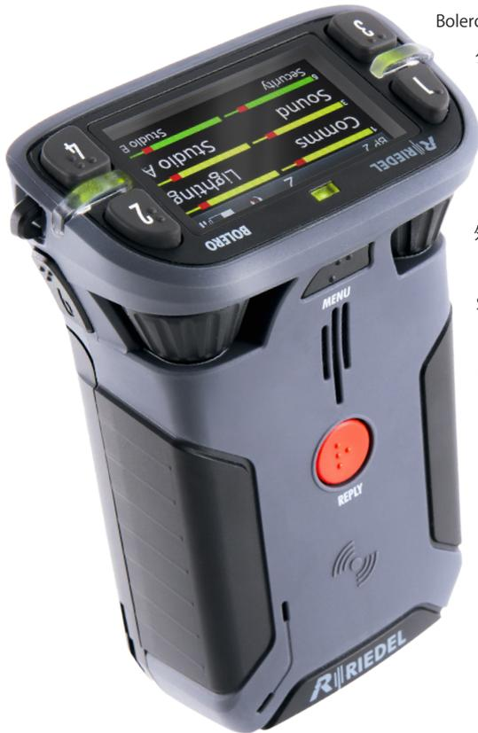
Bolero Standalone Link は小規模な設置やモバイル運用、または IP ネットワークが不要な場合に最適なプラグ&プレイのシンプルさを持ちます。Artist インターカム・マトリクスを要することなく 100 台までのアンテナと 100 台までのベルトパックをウェブ・ブラウザを介して素早くかつ簡単に設定できます。アンテナはリダンダント・リングまたはディジーチェーン・トポロジー内に配置したり、CAT5 ケーブルを使って個別に配備することが可能です。さらに NSA-002A ストリーム・アダプターを使用して Bolero を他のインターカム・システムにアナログ 4 ワイヤを介して接続したり GPIO を提供して外部機器を手軽に扱うことができます。
